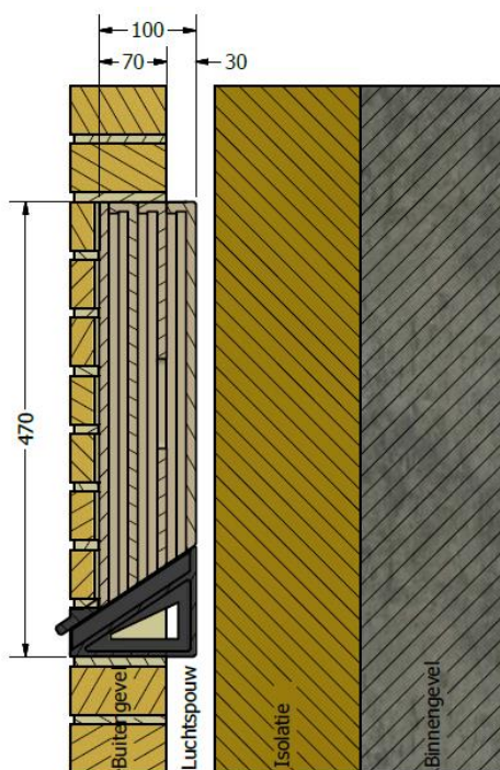
Principe dwarsdoorsnede spouwmuur
